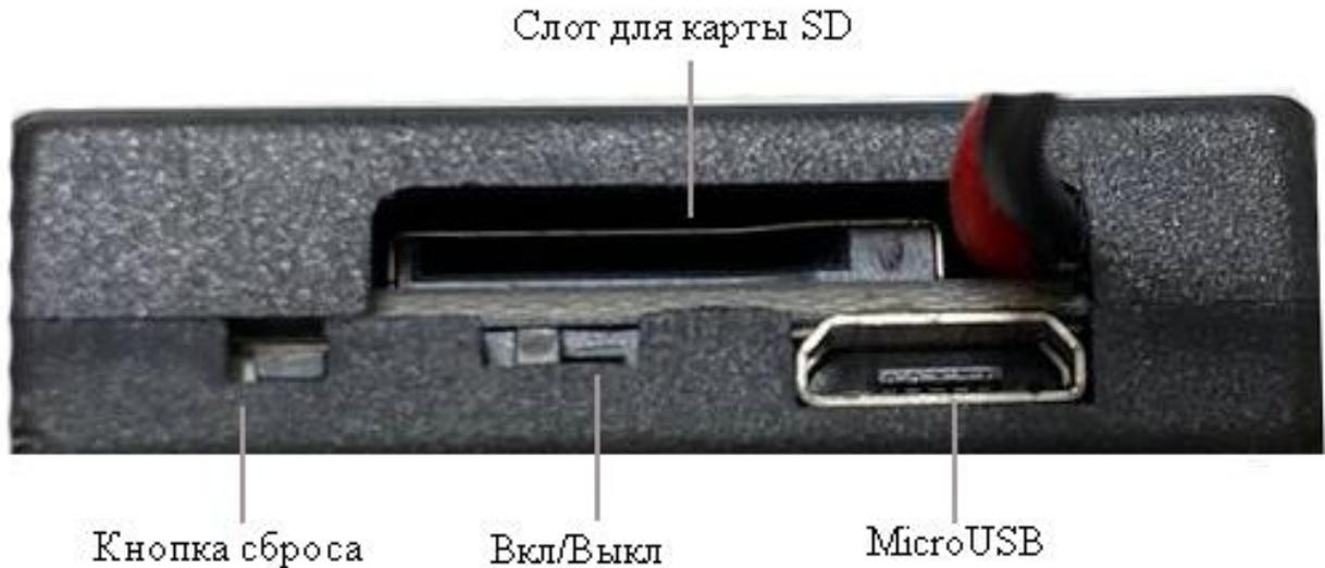
У данной модели миникамеры имеется тумблер включения и отключения устройства Вкл/Выкл, кнопка сброса до заводских настроек, слот для карты памяти SD и порт для подключения провода MicroUSB.
